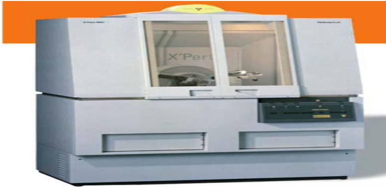
Figura 7. Imagen del difractómetro modelo X'Pert 3 Powder
