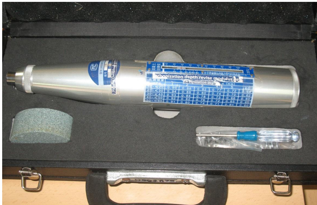
Figura 13. Imagen del esclerómetro
