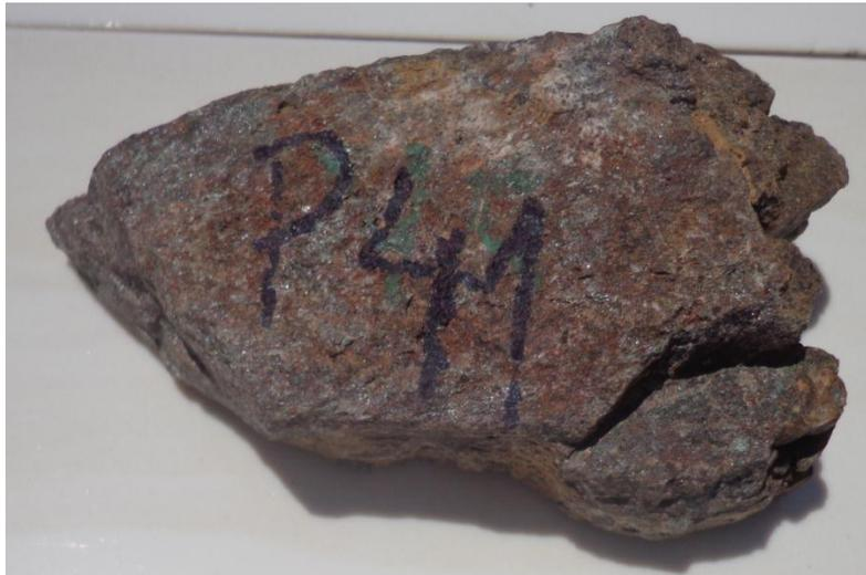
**Figura 3.3.8** Compuesto por calcita, biotita y cuarzo.
