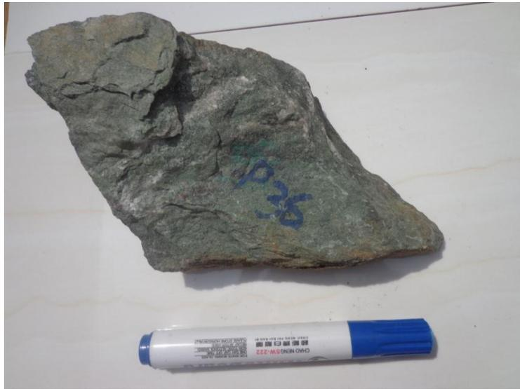
**Figura 3.3.5** Muestra Compuesta por calcita con cuarzo y componente micaceo.
