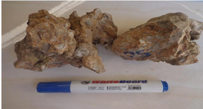
**Figura 3.4** Conglomerado compuesto por con cuarzo, calcita, albita, biotita, pliogopita y matriz carbonatada.
