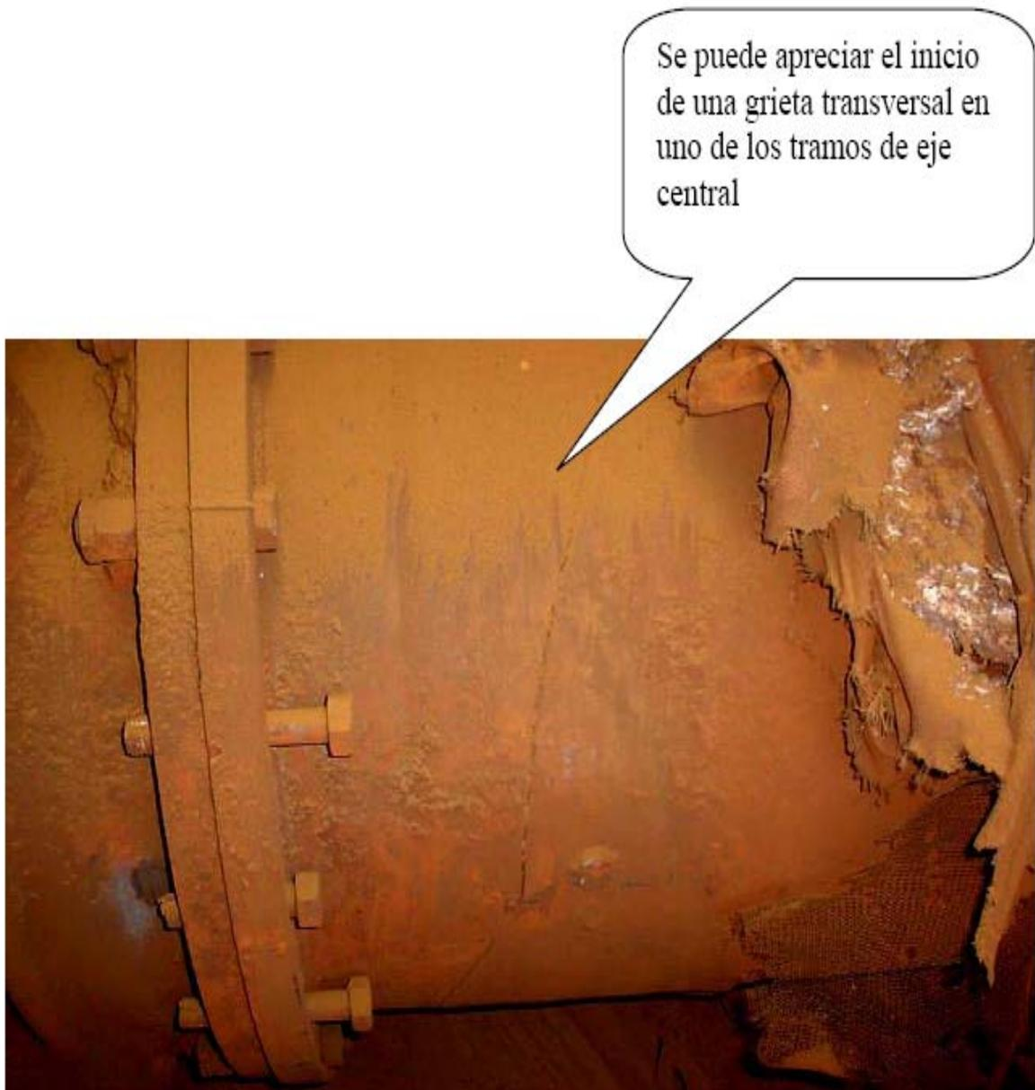
Figura 3. Se observa un tramo del eje central del horno 18 con grieta en el cuerpo, sacado antes que se completara la fractura.
