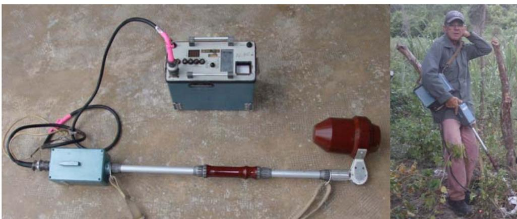
**Fig. 2.2.3:** Magnetómetro protónico ruso *M-33*.
