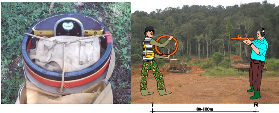
Fig. 2.2.5: Equipo electromagnético (VLEM)- modelo “**Crone**” (Emisor vertical).
