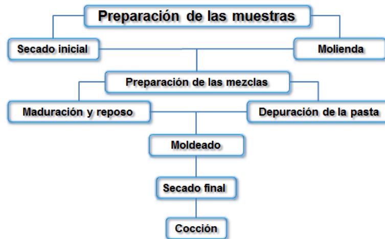
Figura 2.2 Esquema del proceso de preparación de las muestras.
