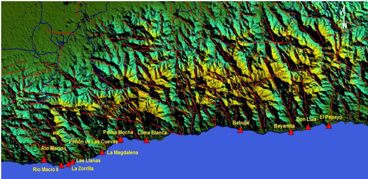
Figura 3.1 Modelo digital del relieve donde se señalan los taludes estudiados en la carretera Granma por su peligro a la ocurrencia de desprendimientos o derrumbes donde existe un relieve muy abrupto.
