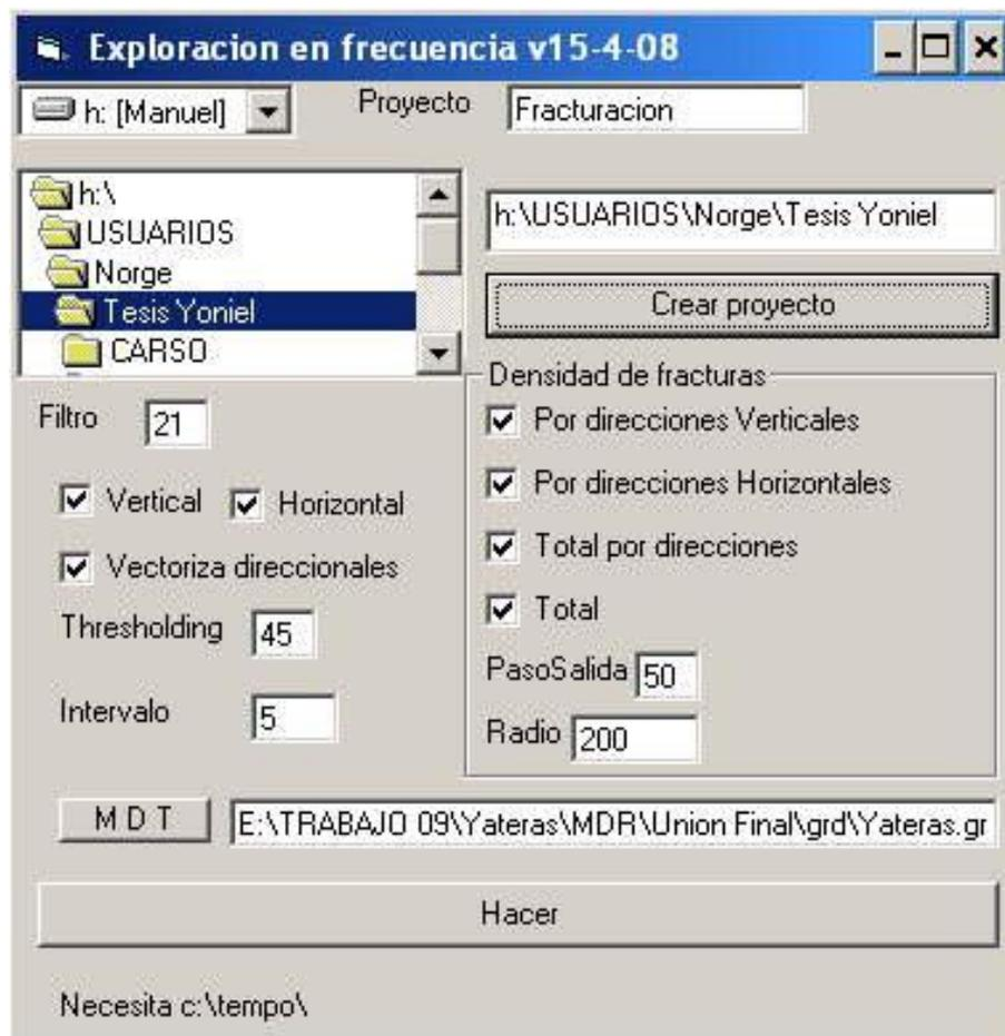
Fig. 3.5.- Programa Exploración en frecuencia para el procesamiento del agrietamiento.
