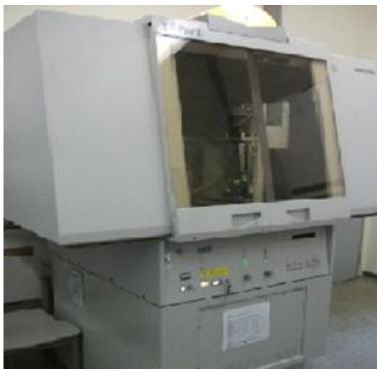
Figura 10. Difractómetro Philips X'Pert utilizado para determinar la composición mineralógica.
