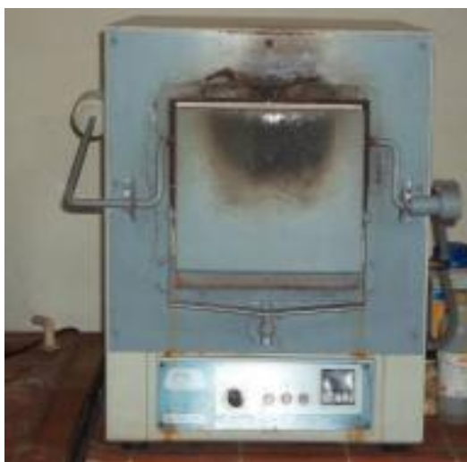
Figura 7. Horno eléctrico J.P Selecta 2000 utilizado para calcinar las tobas zeolitizadas.
