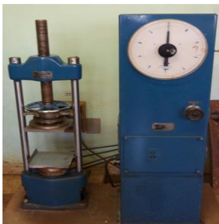
Figura 15. Prensa hidráulica utilizada para la determinación de las resistencias mecánicas.
