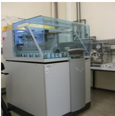
Figura 9. Espectrómetro de fluorescencia de rayos X marca Axios.
