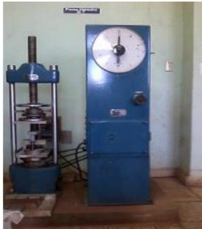
Figura 2.11 Prensa hidráulica de 10 t.
