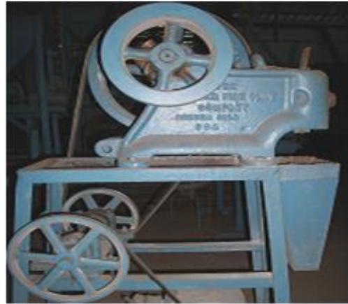
Figura 2.4. Trituradora de mandíbulas TQ (150x75)
