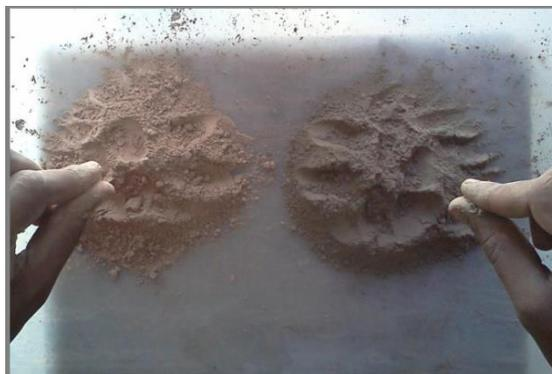
Figura 2.10. Ensayo Visual-Táctil
