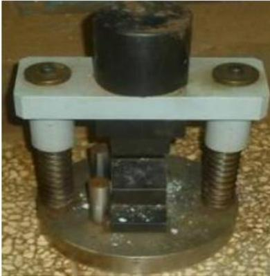
Figura 2.13 Aditamento para la compresión.
