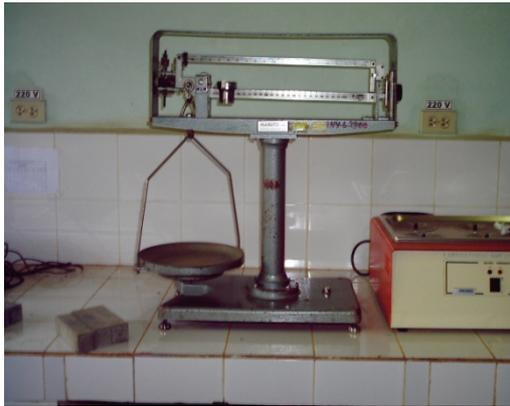
Fotografía 7 Balanza hidrostática.
