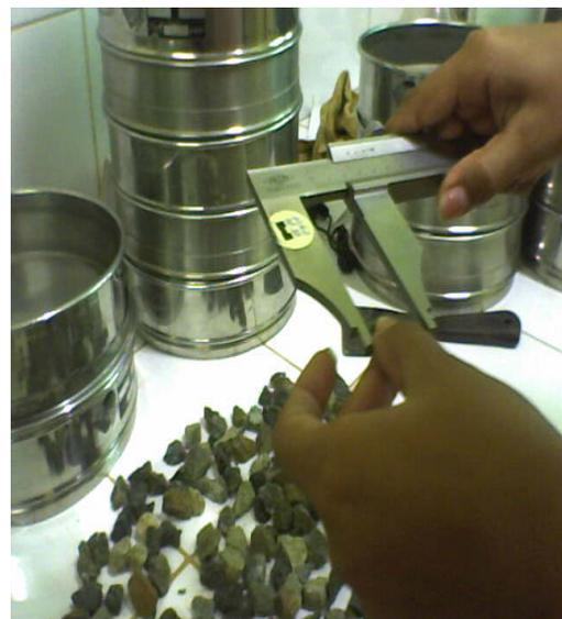
Fotografía 5. Determinación de partículas planas y alargadas con el pie de rey.
