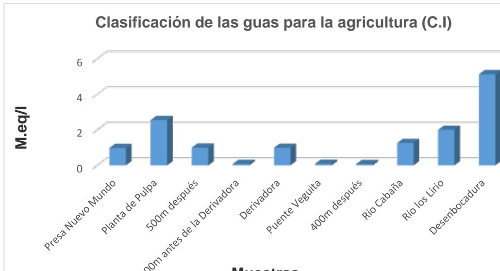
Gráfico 3.15 Clasificación de las aguas por el coeficiente de irrigación (Ci) de Stables.
