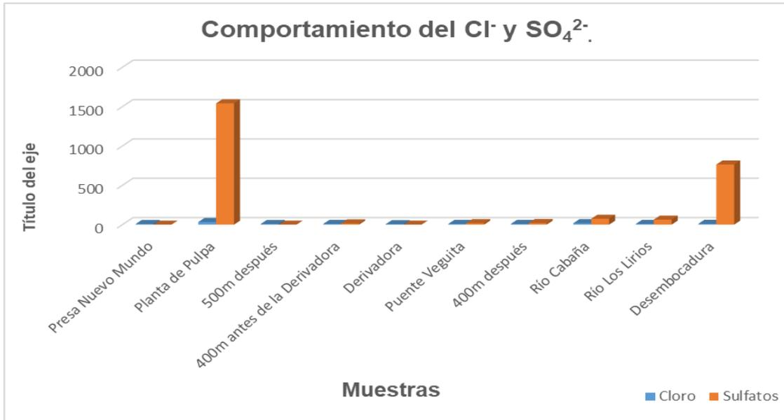
Gráfico 3.7 Comportamiento del Cloruro y los sulfatos en las aguas
