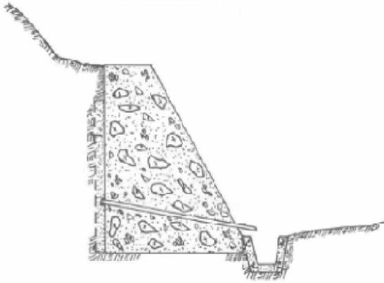
**Figura 3.9** Muros de Gravedad de Concreto.
