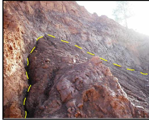
**Foto 2.** Deslizamiento en cortezas lateríticas.
