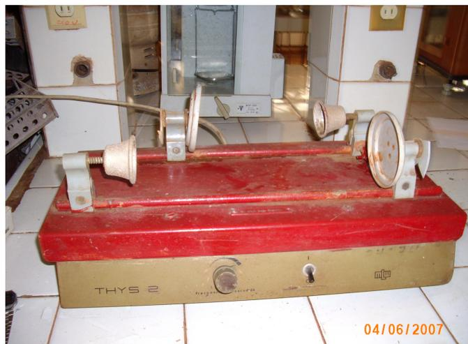
Figura 14. Agitador eléctrico Thys-2 para disgregar las muestras.
