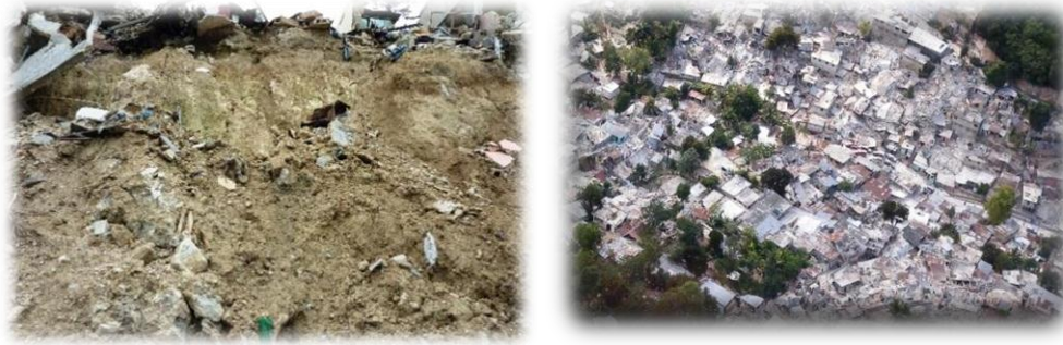
Figura 1: Izquierda. Perfil de los suelos arenosos arcillosos del valle de la Ciudad de Puerto Príncipe, generador de altas intensidades durante el proceso sísmico. Derecha. Se muestra una vista aérea, en planta del terreno, donde todas las viviendas sufrieron grandes daños provocados por su asentamiento en suelos licuables de la ciudad. (Tomado de Herrera, D, 2015)
