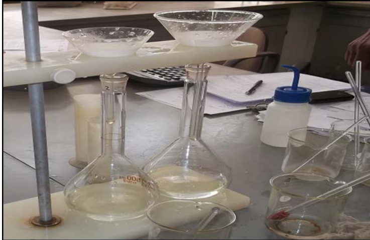
Figura 2.8. Proceso de filtración usando papel filtro nº41, para obtención del componente de la sílice en la arcilla y carbonato.
