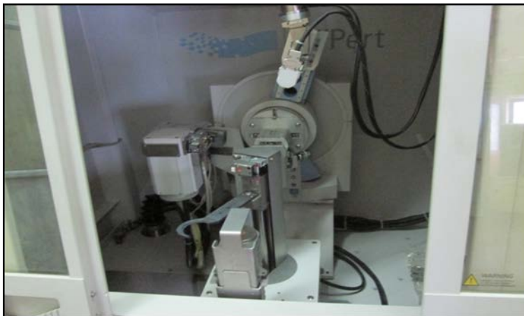
Figura 2.10. Difractómetro de Rayos X (DRX), presentando el porta muestra múltiple para el procesamiento de las fases minerales.
