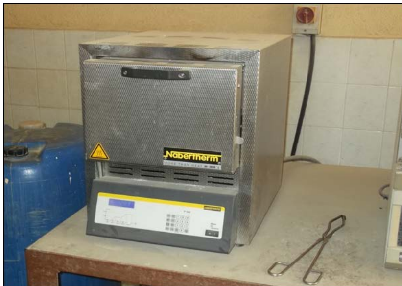
Figura 2.5. Horno o Mufla de calcinación de las muestras de la materia prima mineral.
