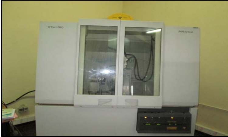
Figura 2.9. Equipo de Difracción de Rayos X, Xpert High Score, marca Philips, modelo PW 3710.
