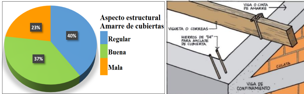
Figura 3.4. Aspecto estructural de amarre de cubiertas
