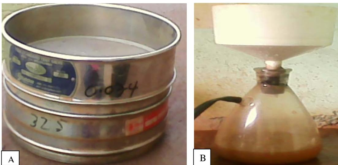
Figura 2.6: Fotografía de los tamices (A) y del sistema de filtración de la fracción fina (B).
