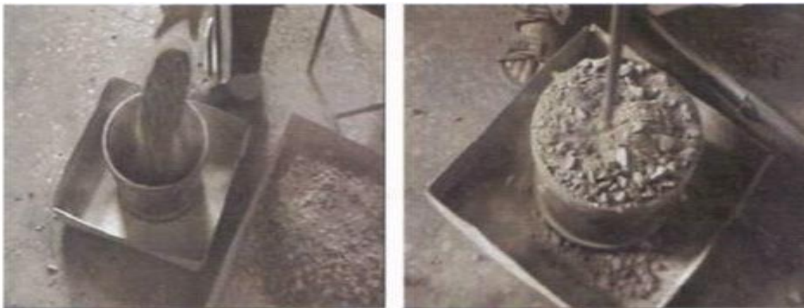
Figura 2.10 Llenado y compactación con barra del recipiente de medición del peso volumétrico.
