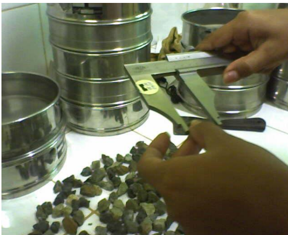
Figura 2.12 Determinación de partículas planas y alargadas con el pie de rey.
