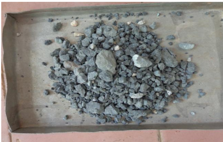
Figura 3.7 Gravadel material del túnel triturada 19.1 mm.
