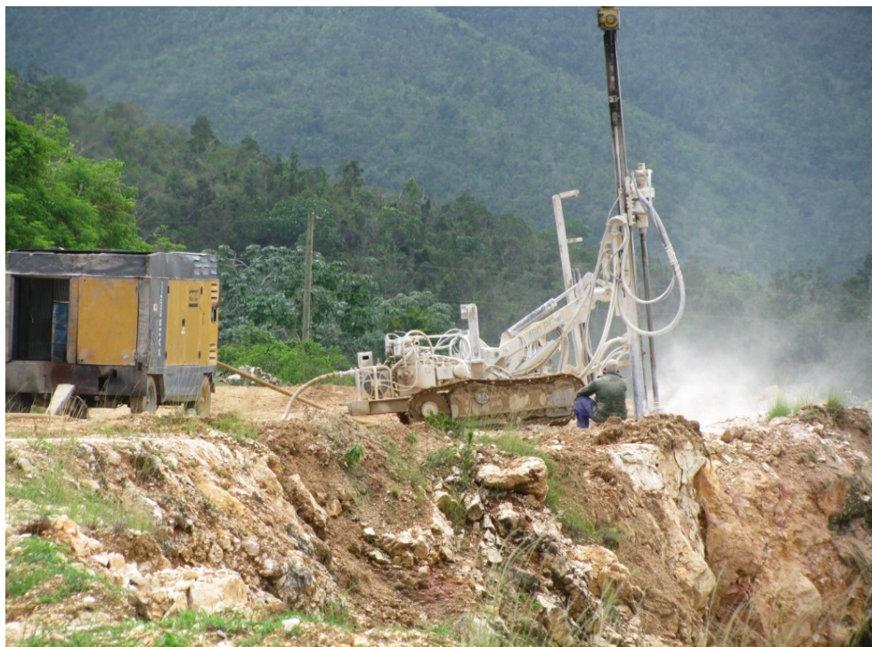
Figura 9. Carretilla barrenadora que utiliza EXPLOMAT en la cantera
