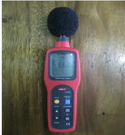
Figura 2.10. Sonómetro utilizado en las mediciones de ruido ambiental
