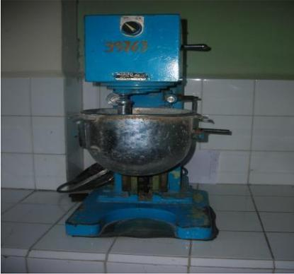
Figura 2.4. Mezcladora para morteros
