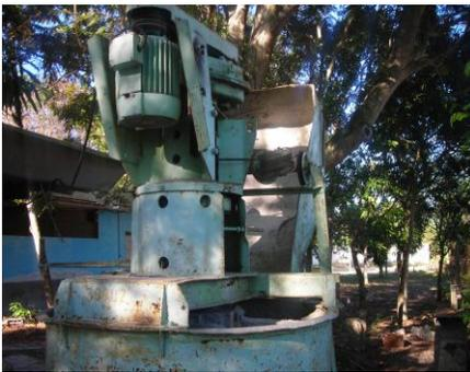
Figura 2.6. Mezcladora para hormigones
