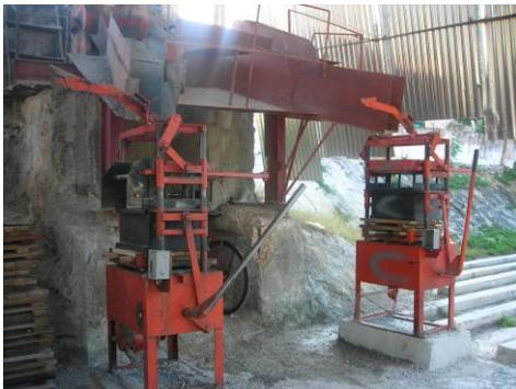
Figura 2.8. Máquina compactadora de bloques
