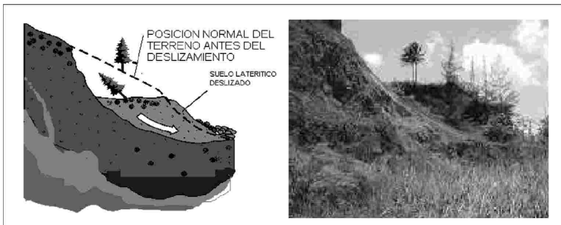
Figura 4.3. Deslizamiento rotacional desarrollado en corteza laterítica. Carretera Moa-Holguín. (Almaguer, 2002).
